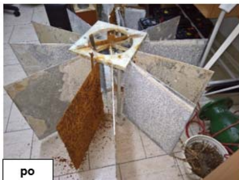
Najväčšia hviezdicová elektróda pred elektroflotačnou aplikáciou a po elektroflotačnej aplikácii na rekreačnej ploche mestskej časti Košíc Nad jazerom
