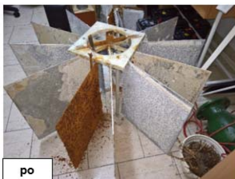
Najväčšia hviezdicová elektróda pred elektroflotačnou aplikáciou a po elektroflotačnej aplikácii na rekreačnej ploche mestskej časti Košíc Nad jazerom
